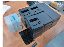
카메라 촬영용 장비를 제작·판매 중인 1인 기업 타임스코프는 3년 전부터 제품 개발을 위해 다양한 장비를 활용하고 있다. 이외에도 제품 양산을 위해 레이저 조각기와 UV 평판 프린터를 활용해 100세트의 제품 외장부를 제작하고 도색했다.
